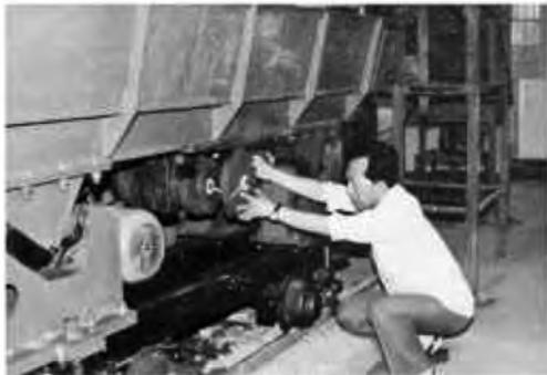
调试新发明的移动式分节振动运输列车工况
